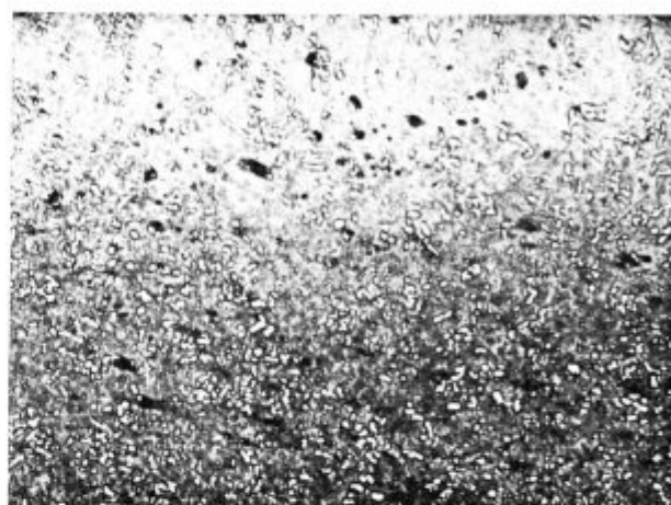
Slika 29 Primer razogljicene plasti orodnega jekla Č. 4150 - OCR 12.
