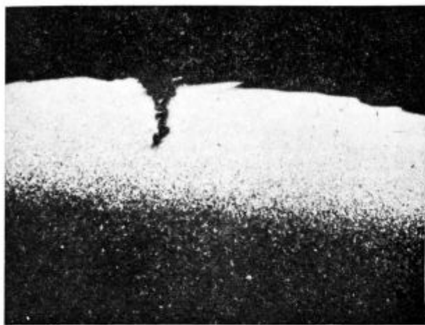
Slika 35 Razpoka v razogljiveni plasti jekla Č. 4732 nastala zaradi termičnih napetosti pri kaljenju.
