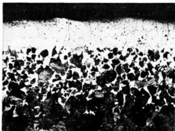
Slika 19 Delno razogljiveno nizko legirano jeklo približno evtektoidne sestave.
