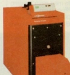
Paromat-Triplex 80 do 1 750 kW nizkotemperaturni ogrevalni kotel na olje/plin. Posebej varčen zaradi večslojnih konvektivnih ogrevalnih površin v tretjem vleku dimnih plinov
