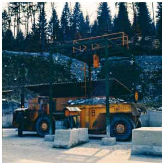
Moderni jamski kamion z nosilnostjo 12 ton, na merilnem mestu RV-3, pred glavnim izvoznim rovom P-11, kjer se je avtomatsko merila celotna količina izkopnine in vsebnost urana v njej. V teh t. i. radimetričnih vratih je bila leta 1986, kot prva v Jugoslaviji, izmerjena radioaktivnost, ki jo je povzročila černobilska nesreča.
