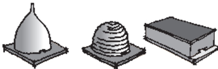
Slika 4: Panji raznih oblik: iz šibja pleten panj, zamazan s kombinacijo blata in kravjaka (za tesnjenje in za izolacijo). Iz ličkanja pleten panj je okrogel, oglat lesen panj pa že ima lastnosti modernega panja: sestavljanje. (Juvanec 2002)
