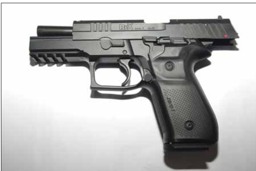
Zaklep v zadnjem položaju, kjer je vidna nagnjena cev navzgor
