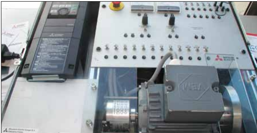
Delovanje frekvenčnega pretvornika najnovejše serije FR-A 800 v enostavni aplikaciji
