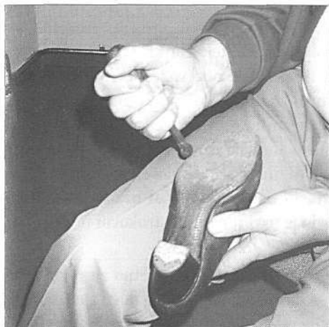
Način uporabe okrasnega kolesca (foto Tita Ovsenar, fototeka Tržiškega muzeja, inv. št. 153). ♦ The use of a decorating wheel (photo Tita Ovsenar, picture library of the Tržič Museum, inv. no. 153).
