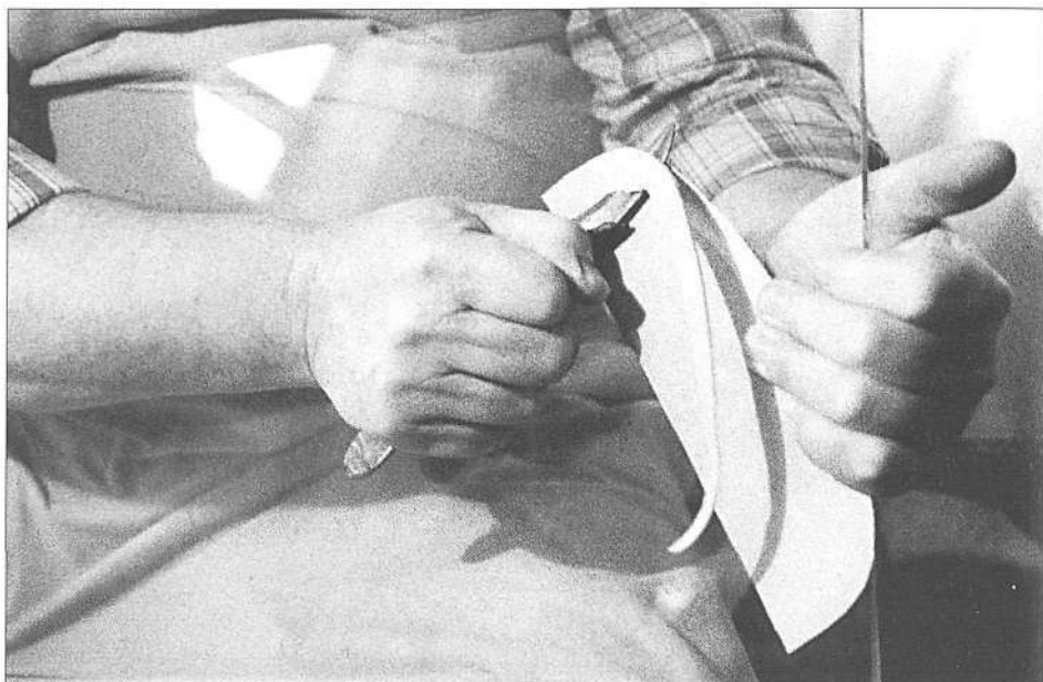
Uporaba noža za tanjšanje (foto Alenka Krašovec, fototeka Tržiškega muzeja, inv. št. 1520). ♦ How a skiving knife is used (photo Alenka Krašovec, picture library of the Tržič Museum, inv. no. 1520).
