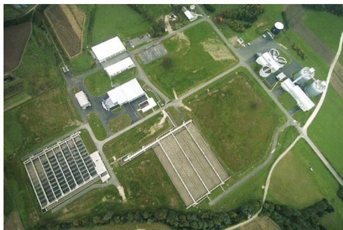
Slika 13 • Tehnološko in prostorsko neracionalna zasnova čistilne naprave v Ljubljani
