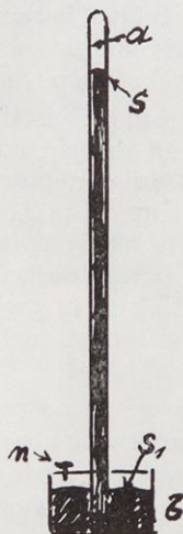
Sl. 24 — Konstrukcija živosrebrnega barometra
