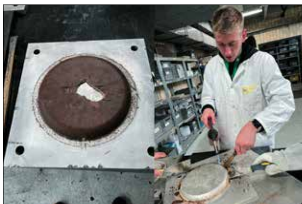
Slika 2. Prvi frizbi se je oprijel kalupa (foto: P. Zore). Figure 2. The first frisbee got stuck to the mould (photo: P. Zore).
