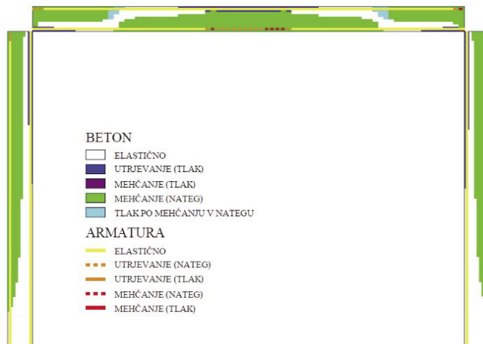
Slika 17 • Stanje betona in armature pri tretji piki na krivulji P-w na sliki 16 za mrežo 64C 40B končnih elementov. Oznaka »tlak po mehčanju v nategu« pomeni, da se je tam razpoka zaprla in beton nosi v tlaku
