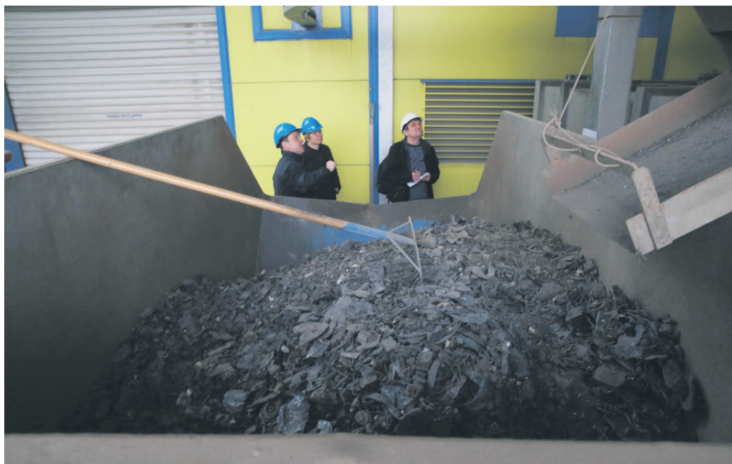
Od skupno prejetih količin odpadkov v Toplarno Celje ostane po toplotni obdelavi približno 16 odstotkov odpadkov. Na fotografiji zabojnik za pepel in žlindro, ki nastaneta kot nenevarna ostanka izgorevanja odpadkov in sta odložena v centru za ravnanje z odpadki v Bukovžlaku.
