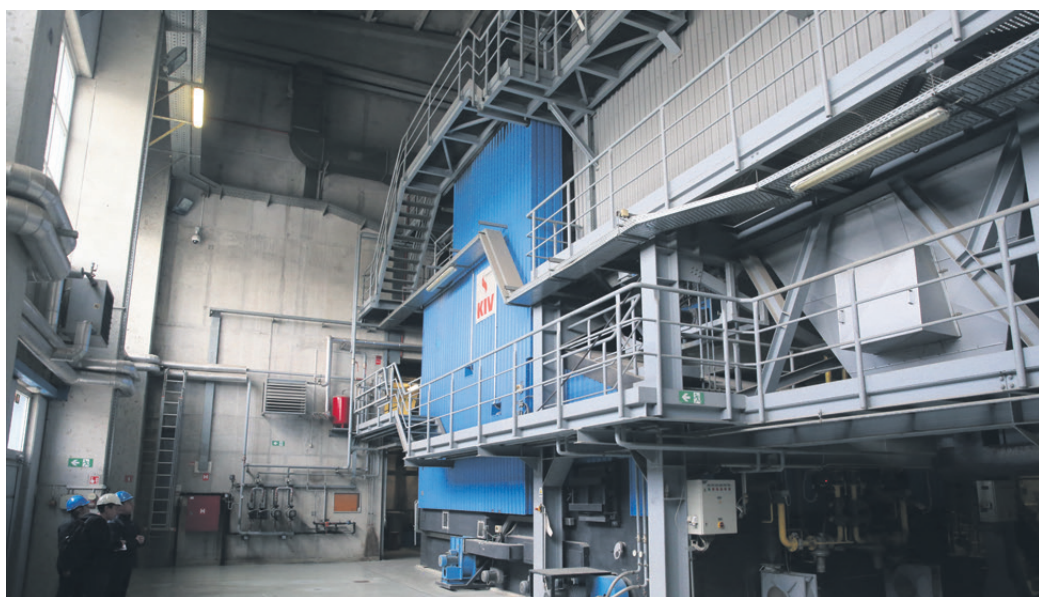
Kurišče, kjer izgorevajo odpadki, ki so mešanica lahke frakcije in blata čistilne naprave.
