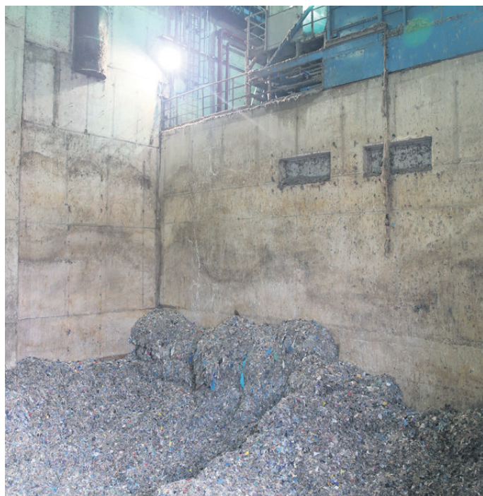
Zalogovnik (skladišče) lahke frakcije odpadkov z zmogljivostjo 1.400 m 3 , dnevno lahko sprejme do 150 ton odpadkov. Zmogljivost zalagovnika blata čistilne naprave je 75 m 3 , dnevno lahko sprejme do 25 ton odpadkov.
