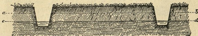
Pod. 27. Osuševanje z globokimi jarki. Prejšnje vodno zrcalo ab se je znižalo do črte cd .
