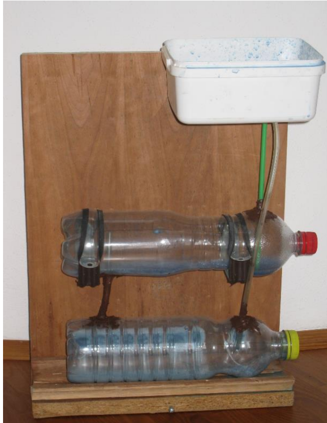
Slika 5: Heronova fontana (izdelek učencev)
