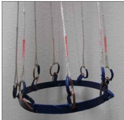
Slika 10: Izboljšava pritrditve padala na sondo.
