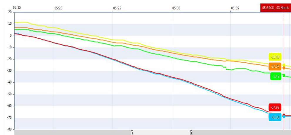
Slika 8: Časovni potek temperature na petih merilnih mestih: modra – zunanja površina sonde, rdeča – biološki vzorec na zunanjem delu sonde, zelena – 1,5 cm pod površino sonde, oranžna – biološki vzorec v notranjosti sonde, rumena – temperatura zbirnika podatkov.
