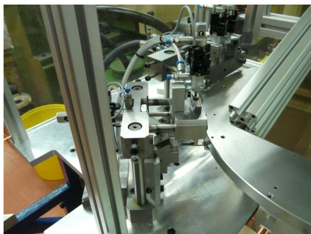
Slika 23: Delovna postaja za embaliranje tuljav (vir: avtor naloge)
