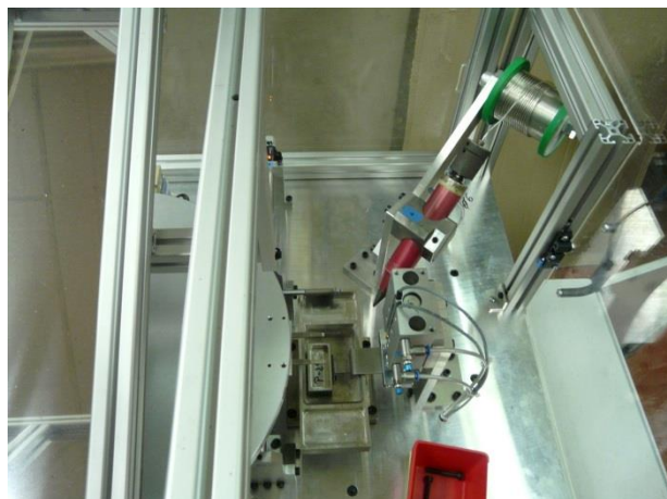
Slika 19: Delovna postaja za spajkanje priključkov tuljave (vir: avtor naloge)
