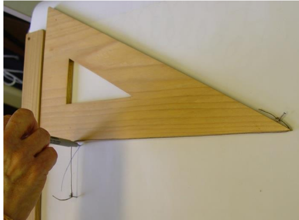
Slika 7: Doma izdelana preprosta naprava za risanje parabole.
