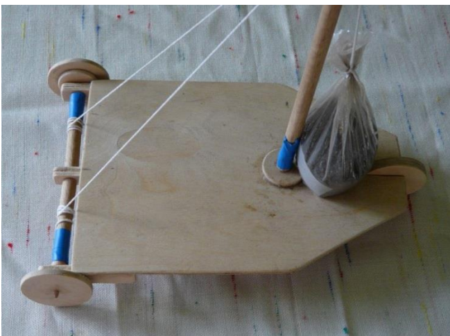
Slika 3: Heronov avtomat – prvi robot (izdelek učenca)
