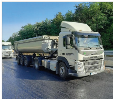
Slika 15. Ukrepi za preprečevanje temperaturne segregacije [Rošer, 2020].
