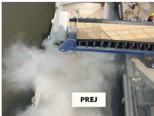
Slika 1 : Prašenje ob pretovarjanju sipkega tovora brez lijaka DSH in z uporabo tega lijaka
