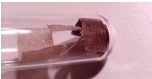
Slika 3 : Izrezki filtra za vzorec industrijskih delcev
