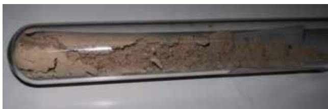
Slika 4 : Vzorec opazovanega testnega prahu (MTD po ISO 16889)
