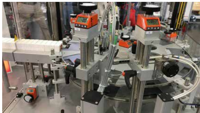
Uporaba Elesa+Ganter elektronskih kazalnikov položaja DD52R-E-RF na pakirnem stroju JW Verpackungstechnik
