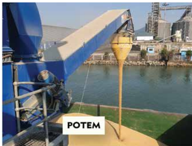
Slika 1 : Prašenje ob pretovarjanju sipkega tovora brez lijaka DSH in z uporabo tega lijaka
