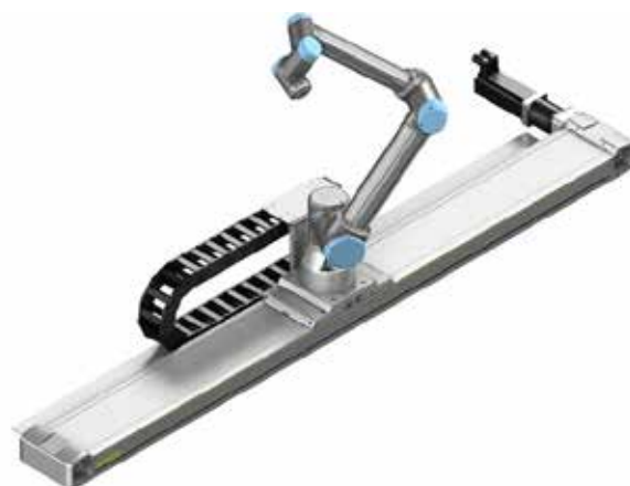
Slika 1 : Cobot RU10e z dodano sedmo linearno osjo HIWIN HT250B
