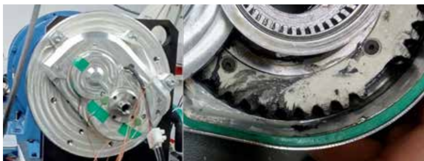
Slika 3 : Testiranje prototipa A1 na preizkuševališču z zavoro in okvara, do katere je prišlo med testiranjem
