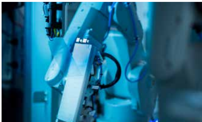
Slika 3 : Odstranjevanje zaščitne folije z robotskim manipulatorjem (Vir: Inea, d. o. o.)
