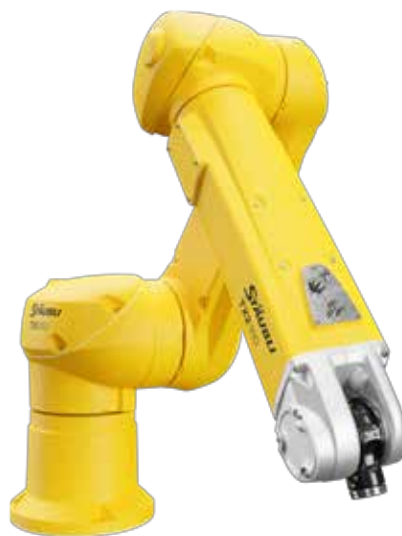
Izvedba TX2-160L z dolgo roko ima doseg 2010 mm, standardna izvedenka pa 1710 mm
