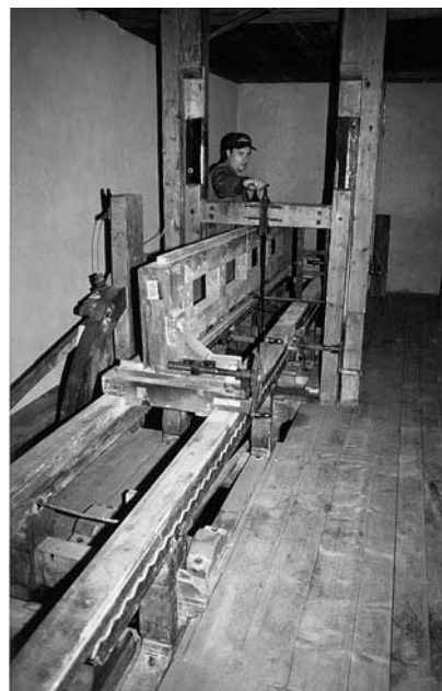
Slika 2. Zataganje žaginega lista jaremskega žagalnega stroja na galeriji furnirnice (foto Vilman, 1998)
