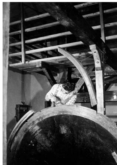
Slika 4. V primeru konserviranja mehanizma bi odpadlo brušenje in razpiranje zob žaginskih segmentov krožnega žagalnega stroja (foto Vilman, 1999)
