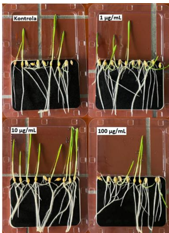
Slika 2: Sedem dni stare rastline semena, katerih zrna so omočena s Hoaglandovo raztopino (kontrola) in različnimi koncentracijami mikroplastike (1 \mu\text{g/mL} , 10 \mu\text{g/mL} in 100 \mu\text{g/mL} ).
