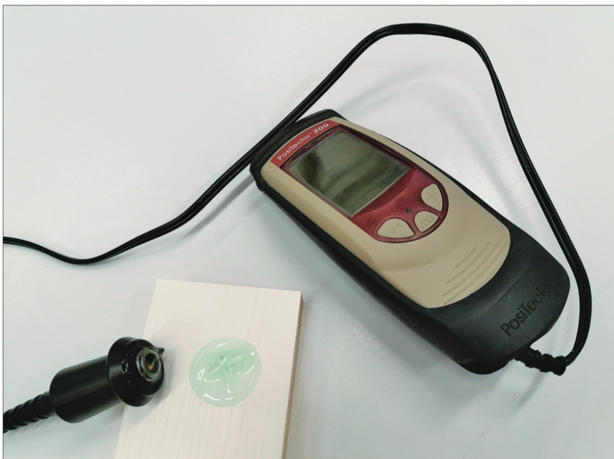
Slika 4. Ultrazvočni merilec debeline suhega filma premaza PosiTector 200.
