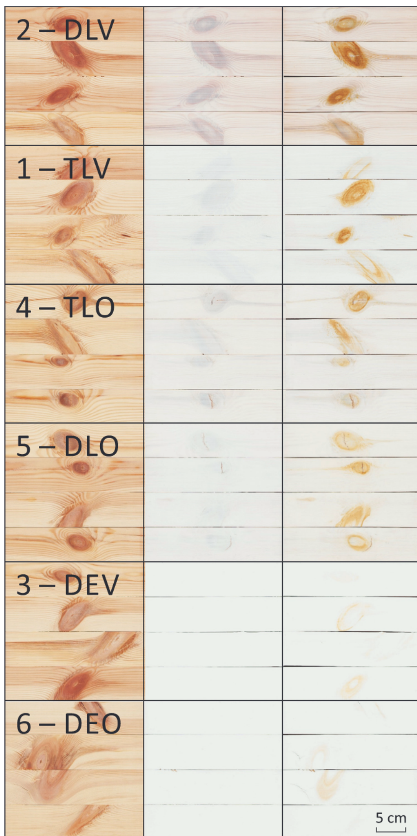
Slika 5. Razvrstitev premaznih sistemov (od 1 do 6) po njihovi odpornosti proti obarvanju (od najslabše zgoraj do najboljše spodaj) glede na barvno razliko po izpostavitvi (levo vzorci pred in v sredini po premazovanju ter desno po UV obsevanju).
