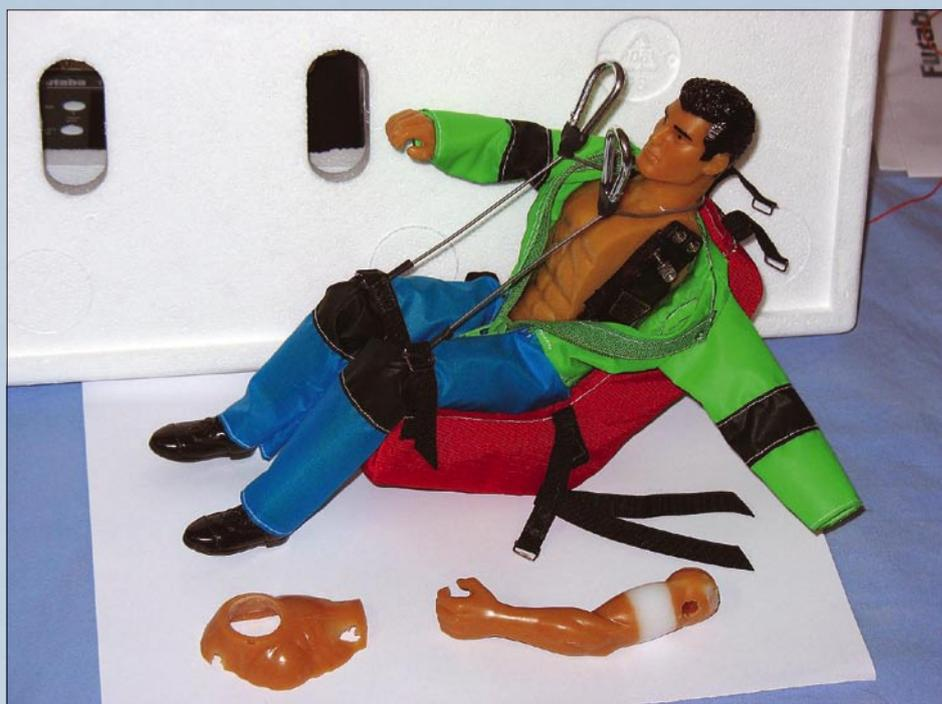
Slika 1. V telo figure sta vgrajena šestkilogramska nizkoprofilna servomehanizma.
