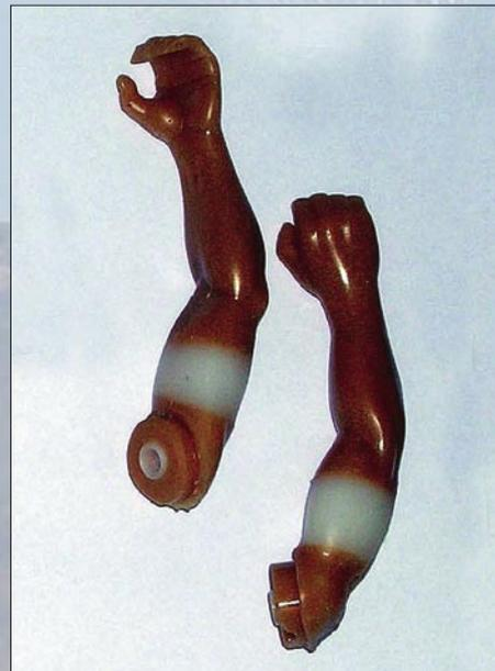
Slika 8. Na rokah so lepo vidna mesta z elastičnim materialom za blaženje sunkov pri pristankih.
