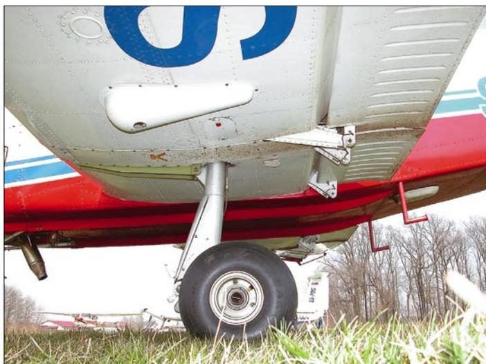
Pritrditev krilc in zakrilc. Pri polmakedi za ta sklop uporabite duraluminijevo pločevino in jo čim bolj natančno obdelajte.
