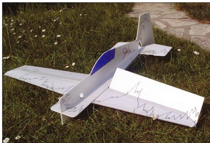
Slika 1. Sestavljen model še brez ojačitve in RV-opreme
