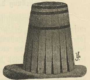
Abb. 24. Die eine Seite eines Obstfasses ist mit Eisenreifen fertiggestellt.
