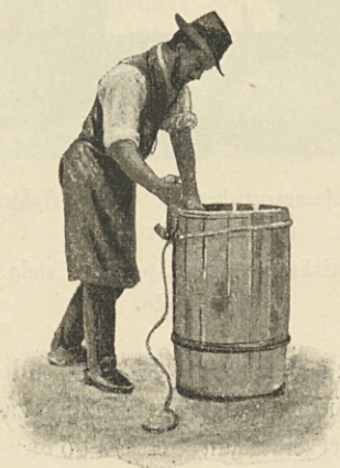
Abb. 25. Zusammenstellen der Obstfässer. Der untere Teil des Fasses ist fertig, der obere wird mit Strick und Prügel zusammengezogen.
