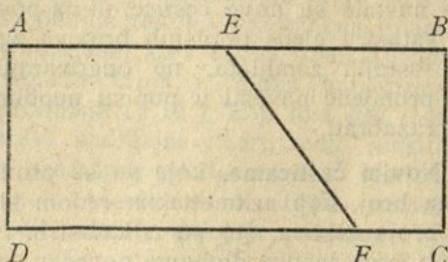
razdijeljena crtom  $EF$  u dvije nove čestice, biti će dovoljno, a da bude moguće ovu novu graničnu crtu naznačiti na mapi, da se opredijeli duljina točke  $E$  od  $A$  i  $B$  i točke  $F$  od  $C$  i  $D$ .
