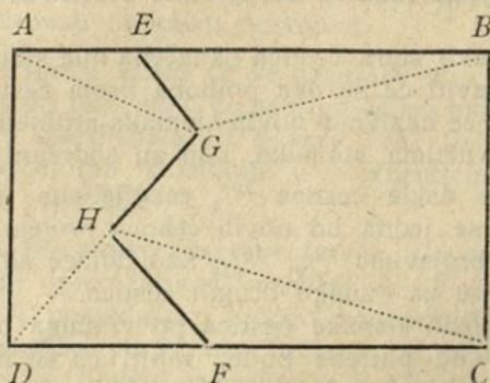
tad će se osim točaka  $E$  i  $F$  opredijeliti još i točka  $G$  mjeranjem crta  $AG$  i  $BG$  te točka  $H$  mjeranjem crta  $CH$  i  $DH$ .
