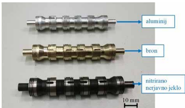
Slika 3 : Izdelani drsniški krmilni bati ( \Phi 12 mm x 75 mm) po brušenju
