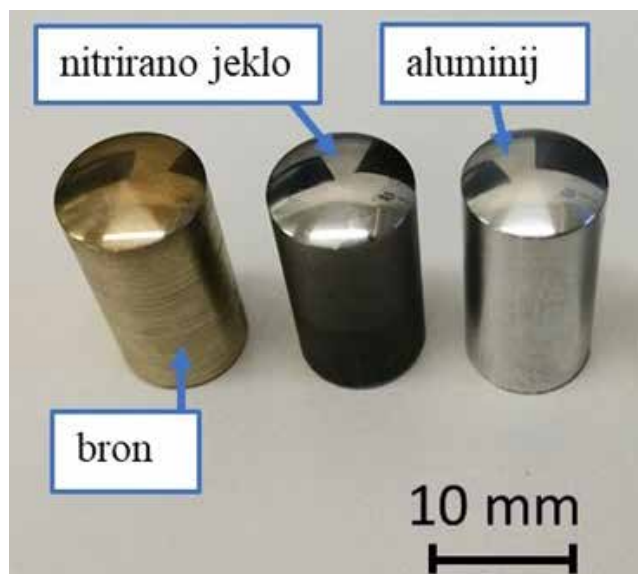
Slika 2 : Trni pred tribološkimi testi (Φ10 mm x 20 mm)
