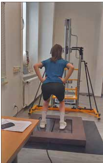
Slika 4. Meritev odrivne moči na bilateralni pritiskovni plošči (osebni arhiv).
