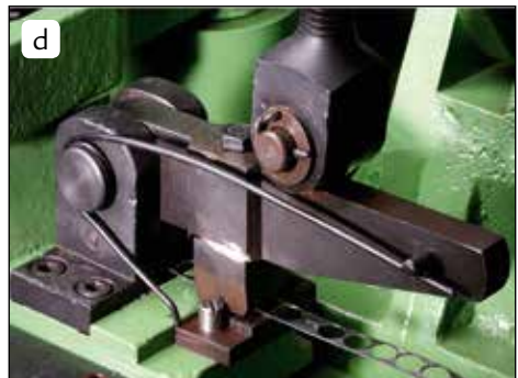
Pridrževanje traku med pomikom. Foto: Andrej Bogataj
