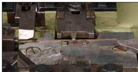
Odrez žice: Pridrževanje žice s krivilno ročico (na sredini) in odrez žice z rezalnim nožem (na levi). Foto: Andrej Bogataj
