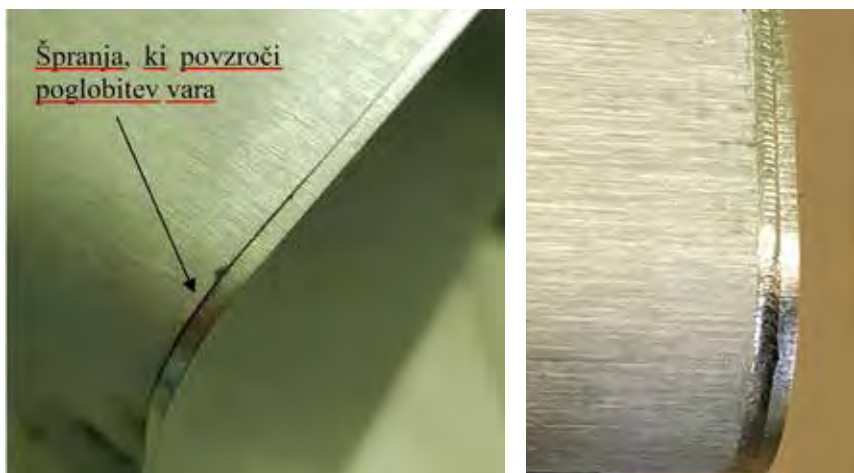
Slika 3 : Priprava zvarnega mesta in lasersko varjena pločevina
