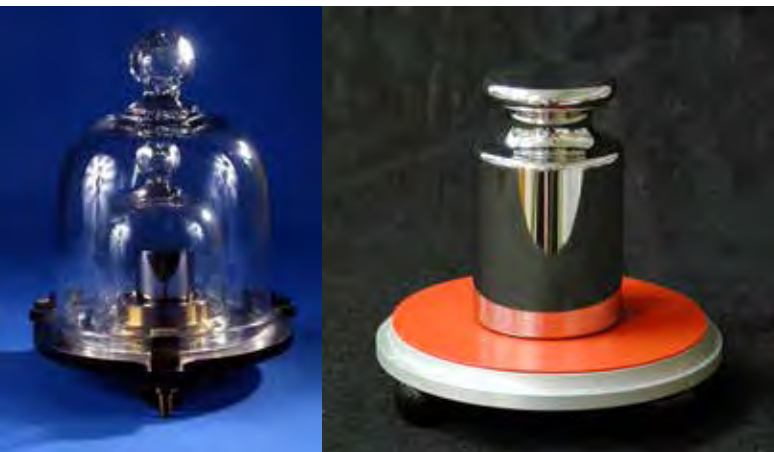
Slika 2 : a – Prakilogram (artefakt), shranjen v Parizu in b – Nacionalni etalon za maso, najbolj točni 1 kg v Sloveniji
