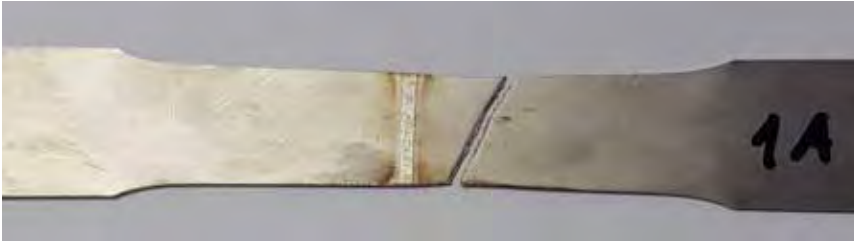
Slika 5 : Epruveta nateznega preizkusa sočelnega vara
