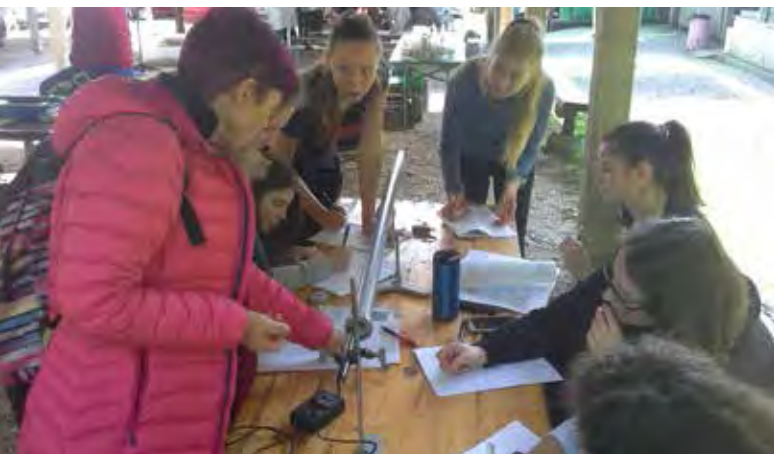
Določanje hitrosti zvoka z merjenjem časovne zakasnitve odbitega zvoka v cevi
