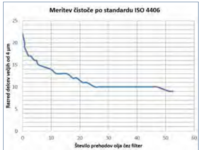
Slika 4 : Meritev čistosti hidravličnega olja pri filtraciji z mobilno filtrirno enoto LFT v odvisnosti od števila prehodov skozi filter.
