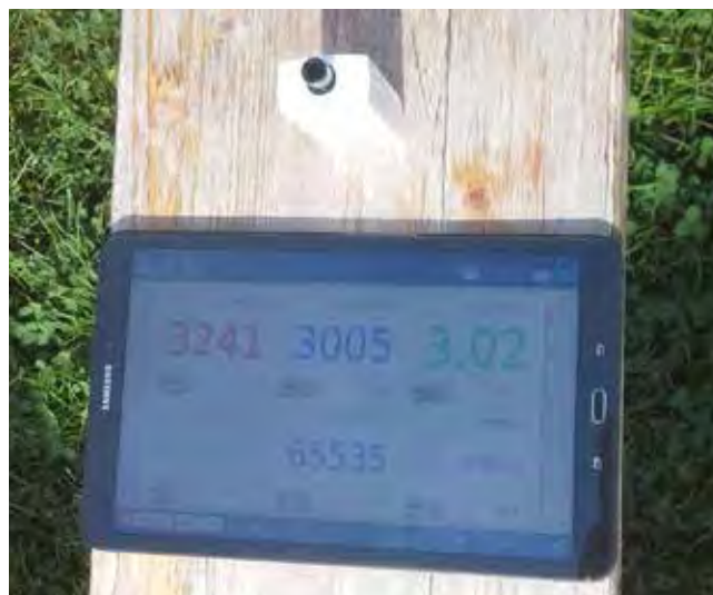
Merjenje gostote energijskega toka svetlobe, osvetljenosti in določanje UVA, UVB ter UV indeksa
