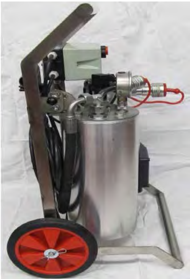
Slika 3 : Mobilna filtrirna enota, izdelana v Laboratoriju za fluidno tehniko (LFT).
