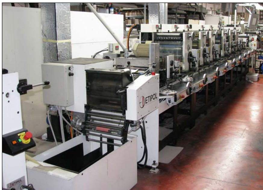
Slika 1. Tiskarski stroj Etipol 340; spredaj je vstopni valj, za njim je 6 tiskarskih postaj
