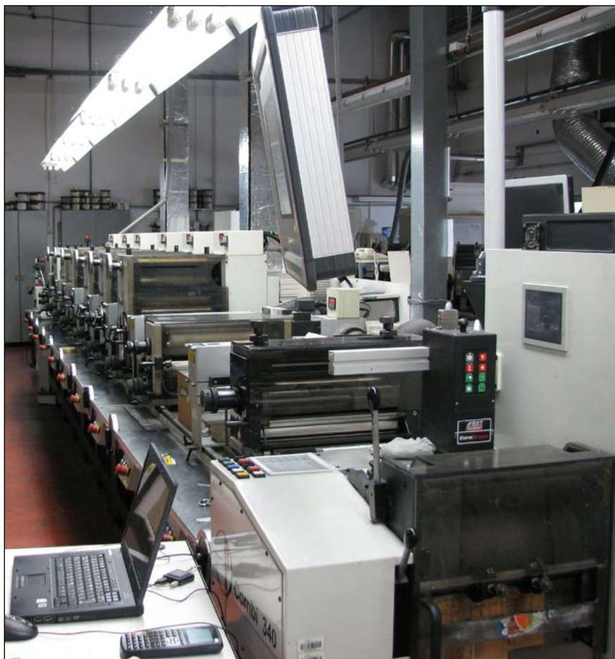
Slika 8. Tiskarski stroj Etipol 340 med predelavo; v ospredju slike je izstopni valj z ročicami za prijem papirja, upravljalne tipke stroja in ekran HMI s CPU-jem nad njimi. Temu sledijo postaje: najprej je postaja za odrez, nato postaja za laminiranje, v ozadju pa 6 tiskarskih postaj.
