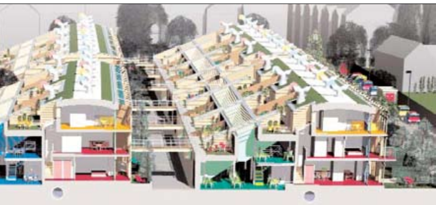
BedZED: prerez skozi naselje, iz katerega se vidi S-J orientacija objektov z vrtovi na jugu in pisarnami na severu, strešnimi terasami, itd ...
