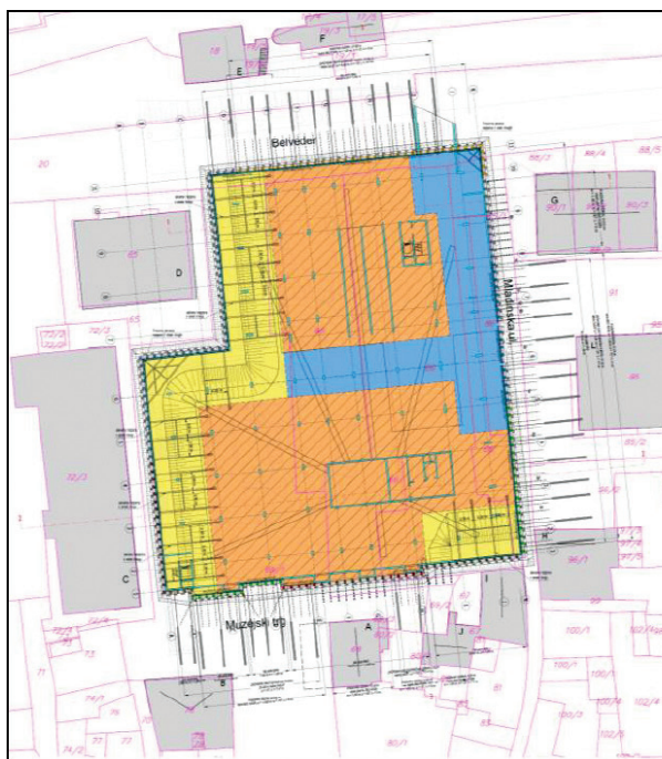
Slika 6. Situacija varovanja gradbene jame, predvidena po PZI (levo) in izvedena (desno) [IRGO, 2020a].
