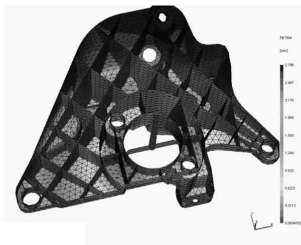
Sl. 4. Simulacija časa zapolnjevanja orodja pri brizganju in analiza izdelka z MKE Fig. 4. Simulation of filling time in injection moulding and FEM analysis
