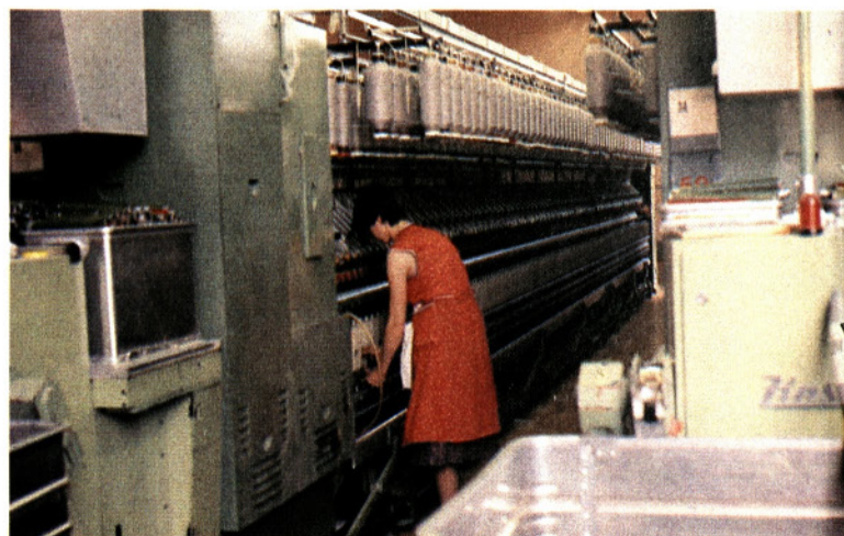
Prstančni predilni stroj firme Zinser z avtomatskim snemom kopsov
