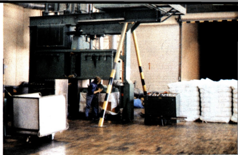
Stiskalnica za izdelavo bal v mesalnici vlaken obratuje od leta 1980
