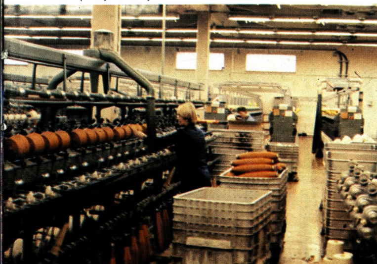
Novi DD sukalni stroji – montirani leta 1986
