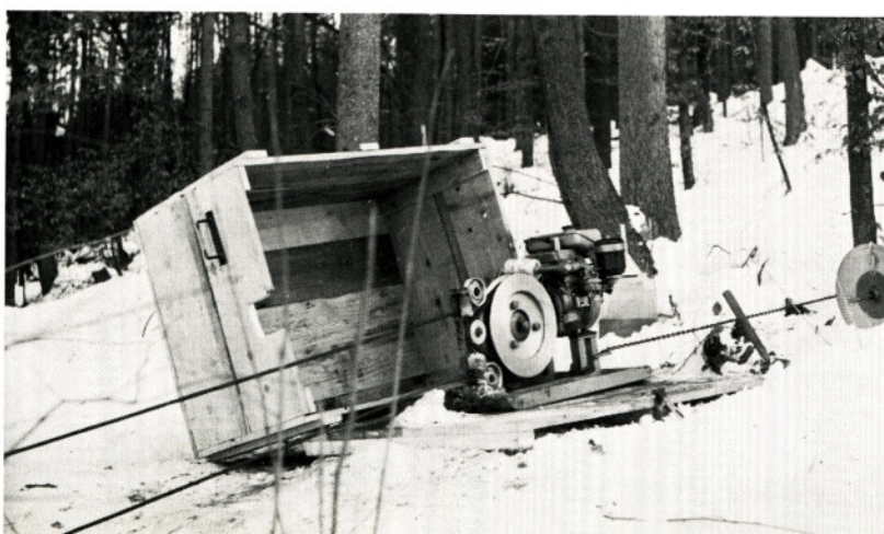
Prenosna smučarska vlečnica, ki so jo izdelali v predilniški mehanični delavnici
