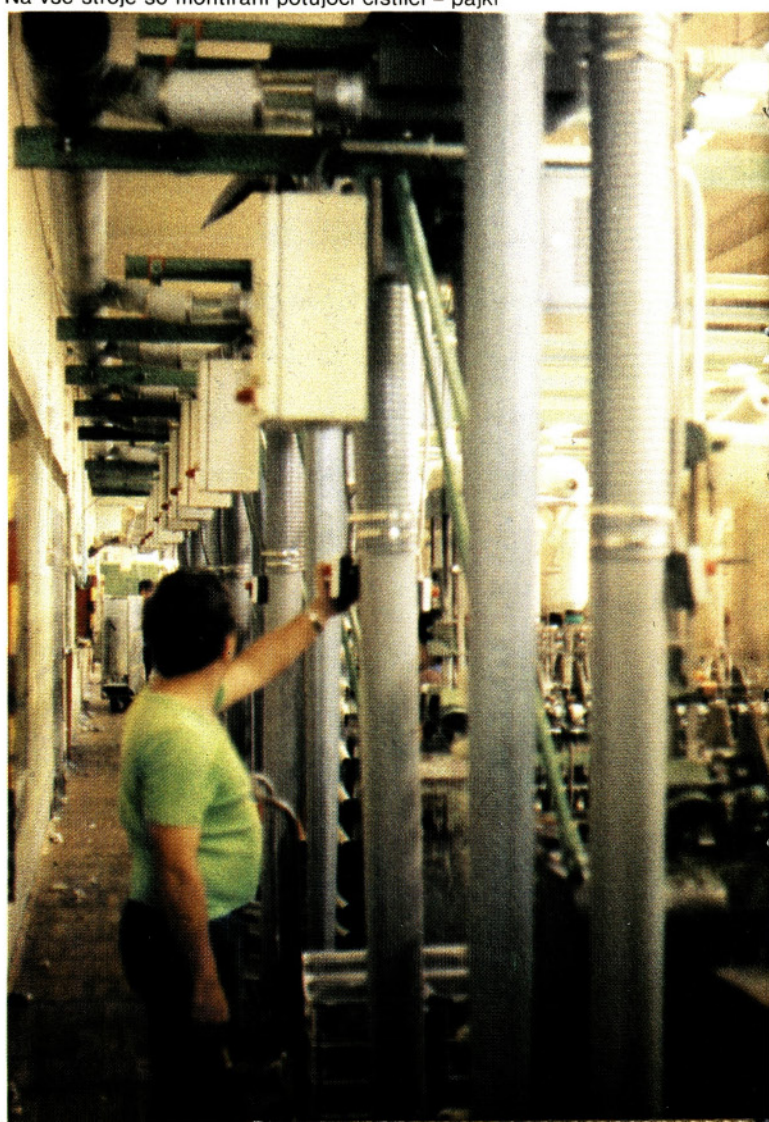
Na vse stroje so montirani potujoči čistilci – pajki
