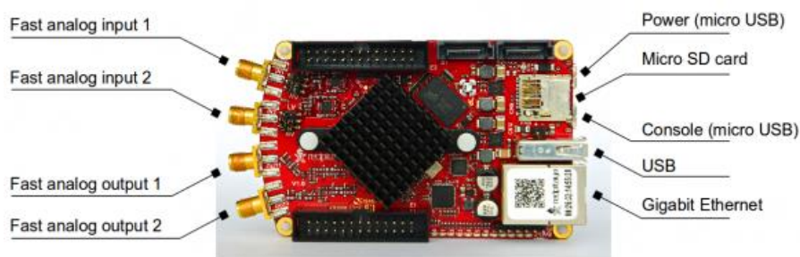
Slika 3. Merilno-računalniška kartica Red Pitaya z osnovnimi priključki.
