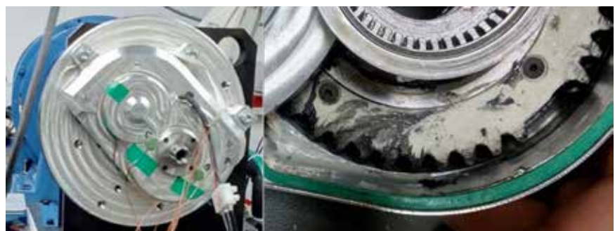
Slika 3 : Testiranje prototipa A1 na preizkuševališču z zavoro in okvara, do katere je prišlo med testiranjem
