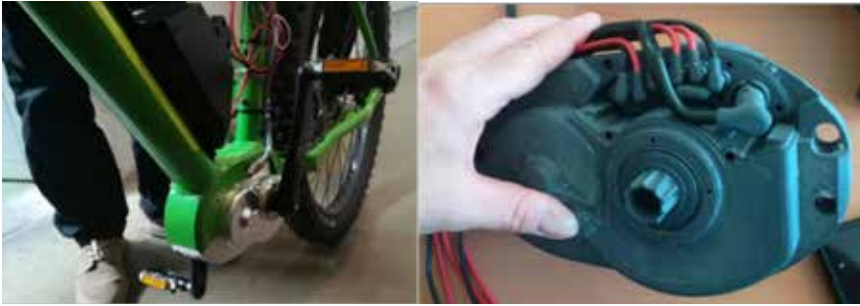
Slika 4 : Slika funkcionalnega prototipa A2, testiranega na kolesu, in 3D tiskanega oblikovnega prototipa, namenjenega za testiranje ustreznosti sklopa priključkov
