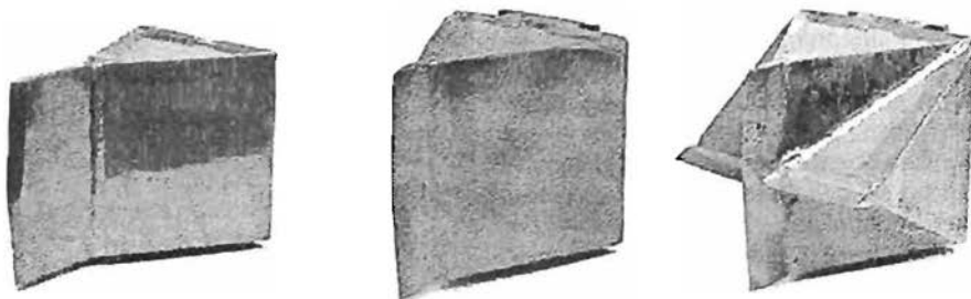
Sl. 4a, b, c: Različni tipi hidravličnih cepilk. a: Težja cepilka, traktorski priključek z možnostjo cepljenja v vodoravnem in navpičnem položaju
