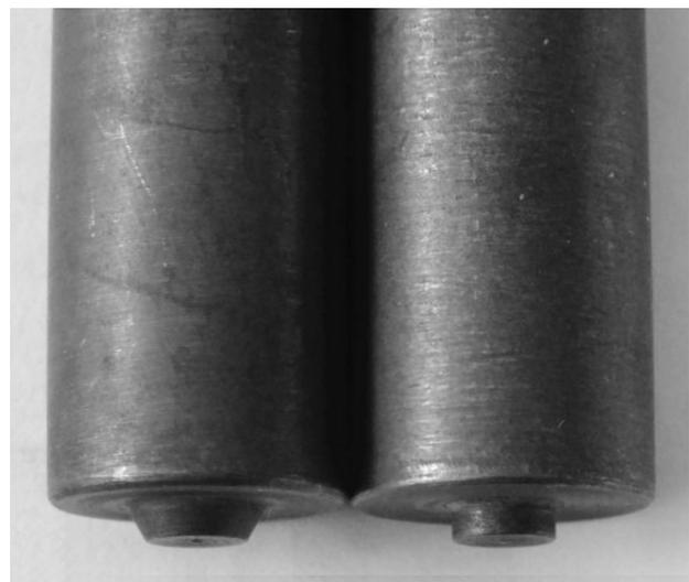
**Figure 2:** Two types of tool used for FSSW: FSSW-T (tapered pin, left) and FSSW-C (circular pin, right)**Slika 2:** Dve vrsti orodja, uporabljeni za FSSW: FSSW-T (konica v obliki prisekanega stožca, levo) in FSSW-C (okrogla konica, desno)
