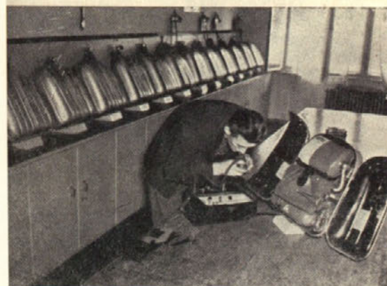
Rudnik Velenje ima tudi najmodernejšo rešilno postajo — kot vojaki stojijo Drägerji — »Custos Lojzek« preizkusa Dräger aparat
