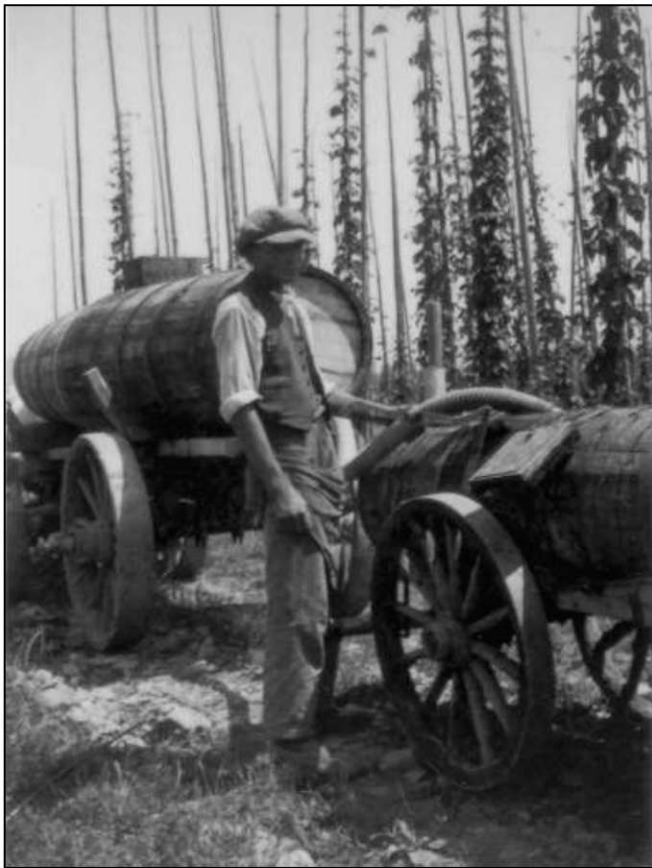
Slika 19: Nova Roblekova lesena cisterna za gnojnico, zalivanje z vodo in škropljenje okrog leta 1930 (vir: fotoarhiv OEIKA FF UL).
