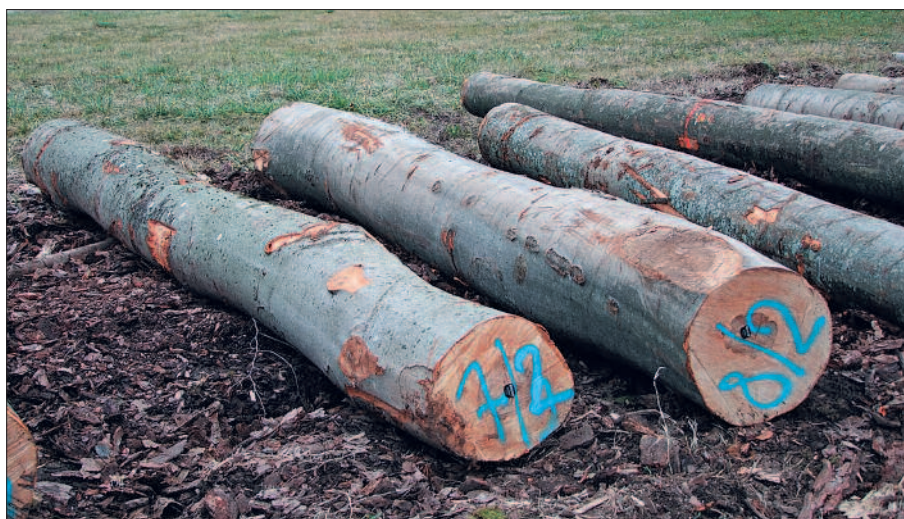
Slika 5. Slepice in napaka srca odločilno vplivajo na kakovost sortimentov
