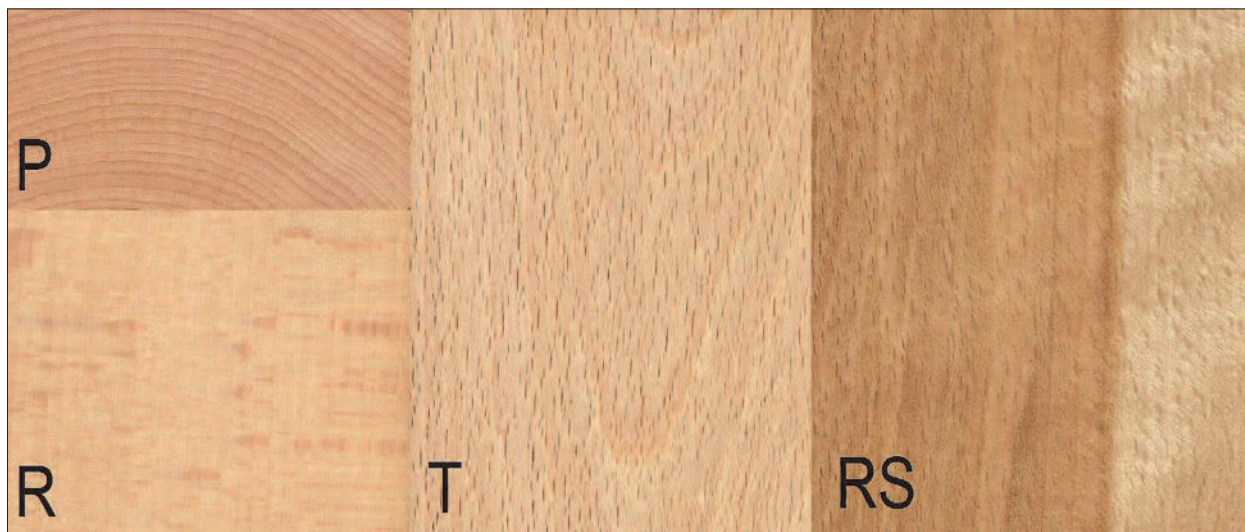
Slika 2. Tekstura lesa bukve v prečnem (P), radialnem (R) in tangencialnem prerezu (T), ter les z rdečim srcem (RS) (Foto: M. Merela).
