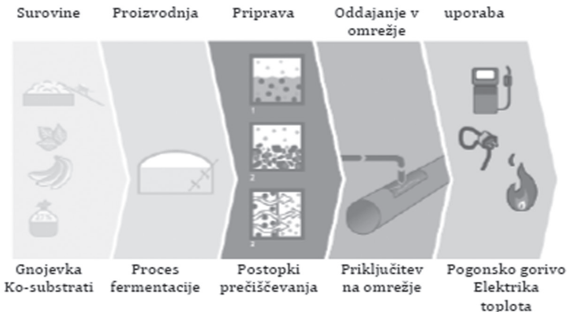
Slika 2: Sistem prečiščevanja bioplina za oddajo biometana v omrežje (Informationsstelle Biomassenergie, 2014)
