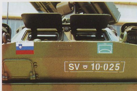
Slika 2. Na levi strani je lepo viden pokrov vitla. To vozilo (10025) ima posebne označbe (zastava in Natov razpoznavni znak za enoto ZO), ki so bile na vozilo postavljene pred odhodom na vajo na Kreto.
