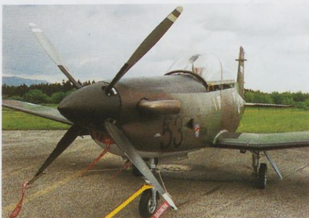
Slika 3. Pogled na nos letala. Pod spinnerjem je vstopnik za zrak, ki ga moramo sami izrezati v trupu makete.
