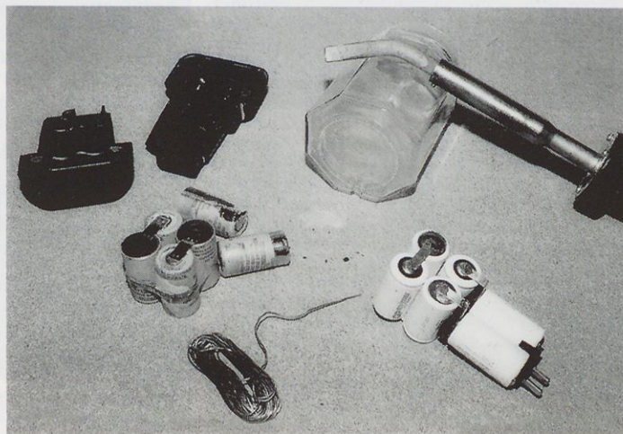
Slika 4. Priključke in povezave med celicami je treba prispajkati čim hitreje, da se izognemo škodljivemu pregrevanju.
