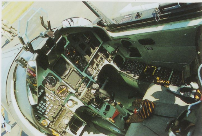
Slika 6. Čelna instrumentna plošča »Hudournika«, L9-61 (316) po opravljeni predelavi v pravi šolski jurišnik
