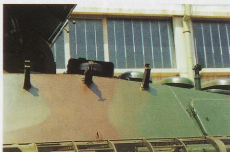
Slika 10. Nosilce, na katere je naslonjen okvir mrežastega nosilca, moramo izdelati sami.
