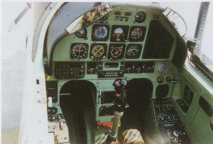
Slika 5. Čelna instrumentna plošča prvih treh pilatusov (PC-9A) (Foto: M. Malec)
