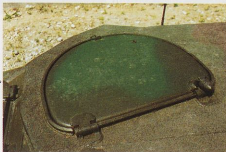
Slika 4. Pokrov odprtine, skozi katero vstopa posadka vozila. Na sliki se jasno vidi tudi hrapava površina oklepa (poseben popis proti drsenju, ki je nanesen na nekatere vrhnjih delih vozila).
