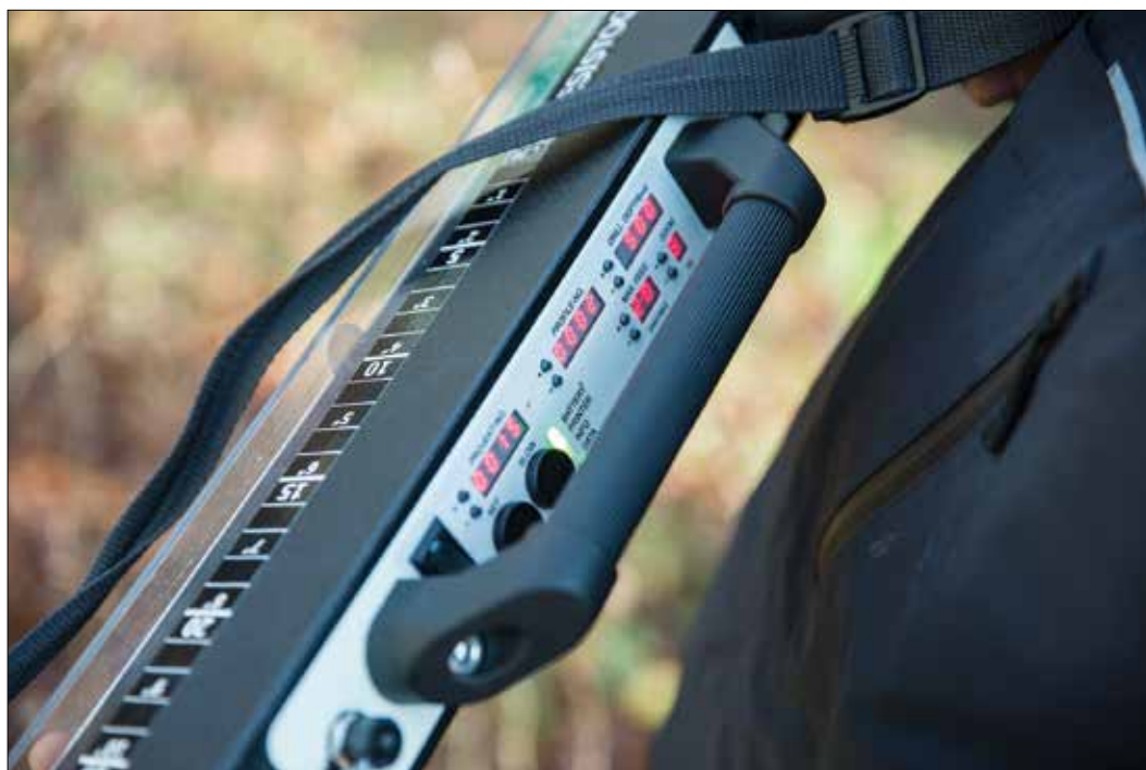
Slika 1: Rezistograf, naprava za merjenje gostote (foto: G. Skoberne)
