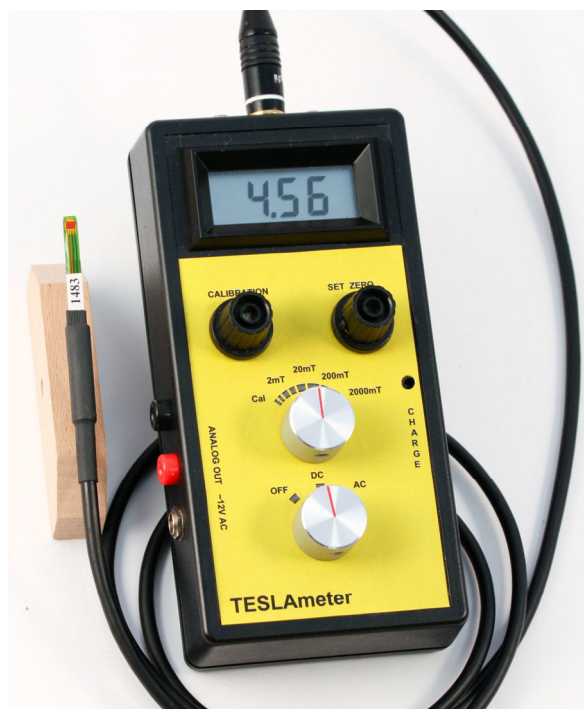
Slika 4: Teslameter-merilnik s priključeno sondo. Na levi strani je viden prikllop za voltmeter.
