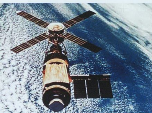
Satelit, napajen s samostojnim sončnim fotonapetostnim sistemom
