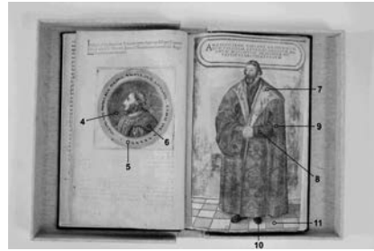
Slika 4: Meritve z metodo PIXE, izvedene na straneh 7v (točke 4–6) in 8r (točke 7–11), stanje po konservatorsko-restavratorskem posegu. (Foto: Mateja Kotar, CKR ARS)
