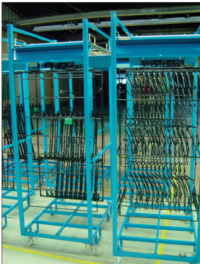
Obešala za polizdelke, namenjene barvanju in za odlaganje že pobarvanih polizdelkov
