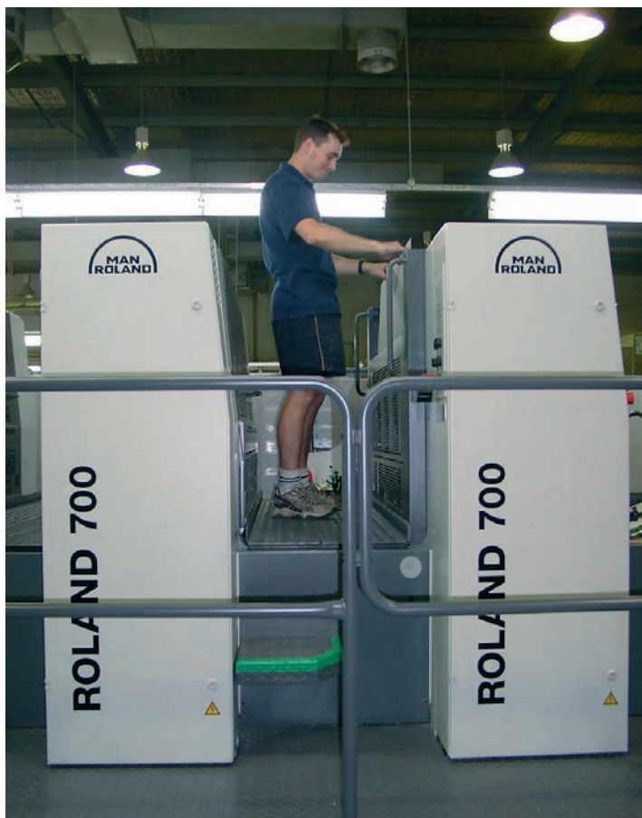
Slika 11. Sistem PPL za polavtomatsko menjavo tiskovnih form.
