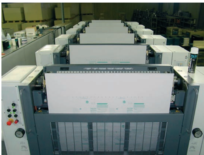
Slika 12. Sistem APL za avtomatsko menjavo tiskovnih form.
