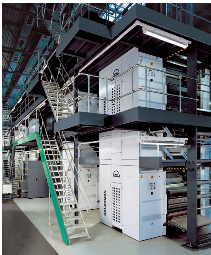
Nova ofsetna rotacija v Delu Colorman ima štiri satelitske enote v dveh tiskovnih stolpih, zato zmora tiskati vse strani časopisa v štirih barvah.
