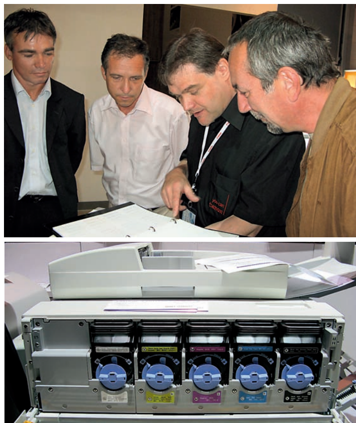
Slika 8. Predstavitel laserskega stroja Canon imagePRESS C1+ na Drupi 2008. Štiri plus ena kartuša za procesne barve in dodatni transparentni toner.
