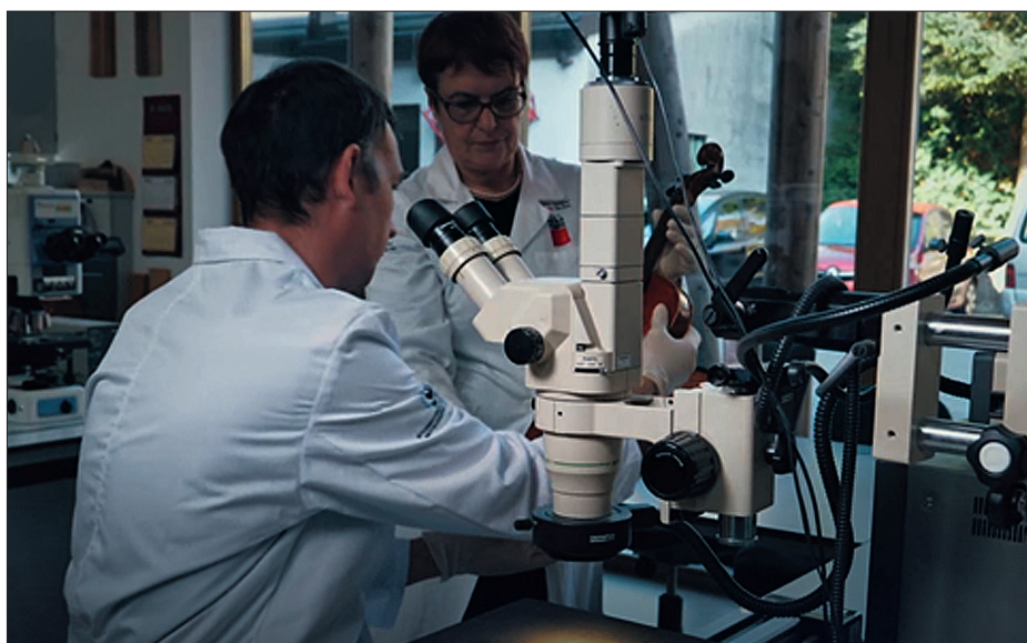
Slika 4. Dendrokronološka analiza violine za določitev starosti in originalnosti instrumenta. Foto: Rado Likon, (Vrhunci..., 2020).
