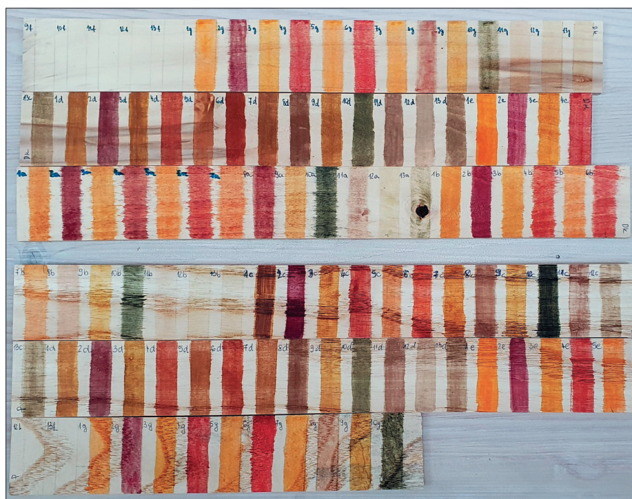
Slika 4. Vzorci lesa navadnega divjega kostanja (zgornja polovica vzorcev) in velikega pajesena (spodnja polovica vzorcev), ki so premazani z različnimi barvili iz invazivnih tujerodnih vrst.
