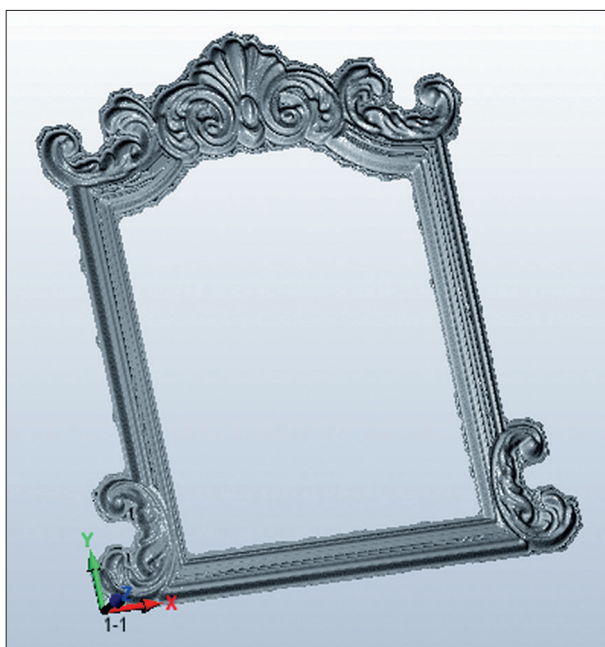
Slika 7. Surovec po operaciji »Constant Z Machining«
