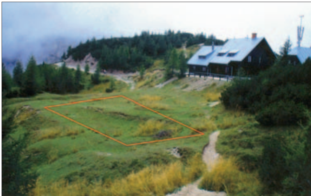
Slika 4: Poštarski dom na Vršiču (1688 m) bi lahko dobil najvišje ležečo rastlinsko čistilno napravo (za 80 PE, površina: 180 do 200 m 2 ). Romb prikazuje možno lego čistilnih gred.
