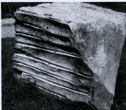
Na fotografiji se vidijo sledi izvrtin, s pomočjo katerih so lahko kamniti blok odlomili v želeni liniji, masiv pa je ostal nepoškodovan. (Fotografija je posneta na gradu Štanjel na Krasu in naj bi služila samo kot prikaz kamnoseškega postopka.)
