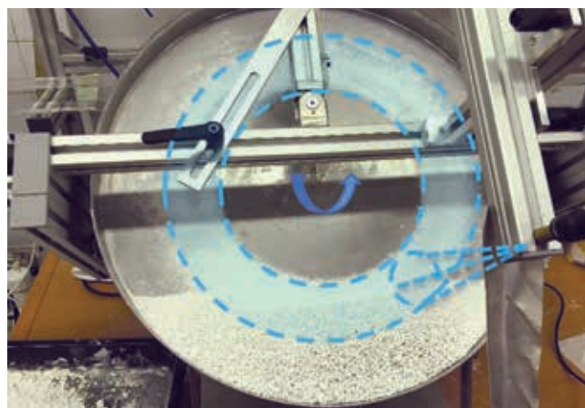
Slika 7 : Granuliranje pri kombinaciji VM + A s pršenjem vode
