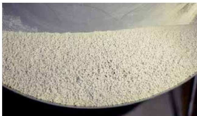
Slika 5 : Stanje granuliranja kombinacije VM + G pri časih 15 s (a) in 30 s (b)
