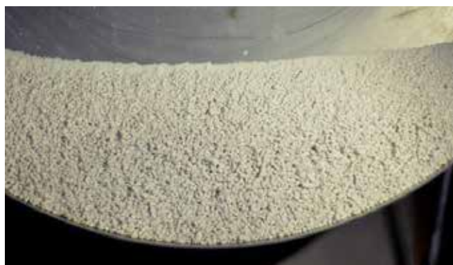
Slika 5 : Stanje granuliranja kombinacije VM + G pri časih 15 s (a) in 30 s (b)
